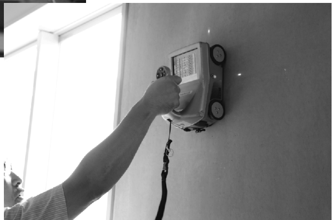
図9 電磁波レーダ法に鉄筋探査の実習
