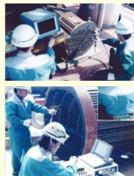
化学プラントにおける定期検査 (熱交換器の過流探傷検査) (株)シーエックスアル殿提供
